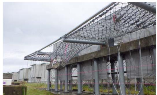
重りの自由落下実験。自前の実験場で実証テストを行えることが、スピーディーな製品開発に欠かせない。
